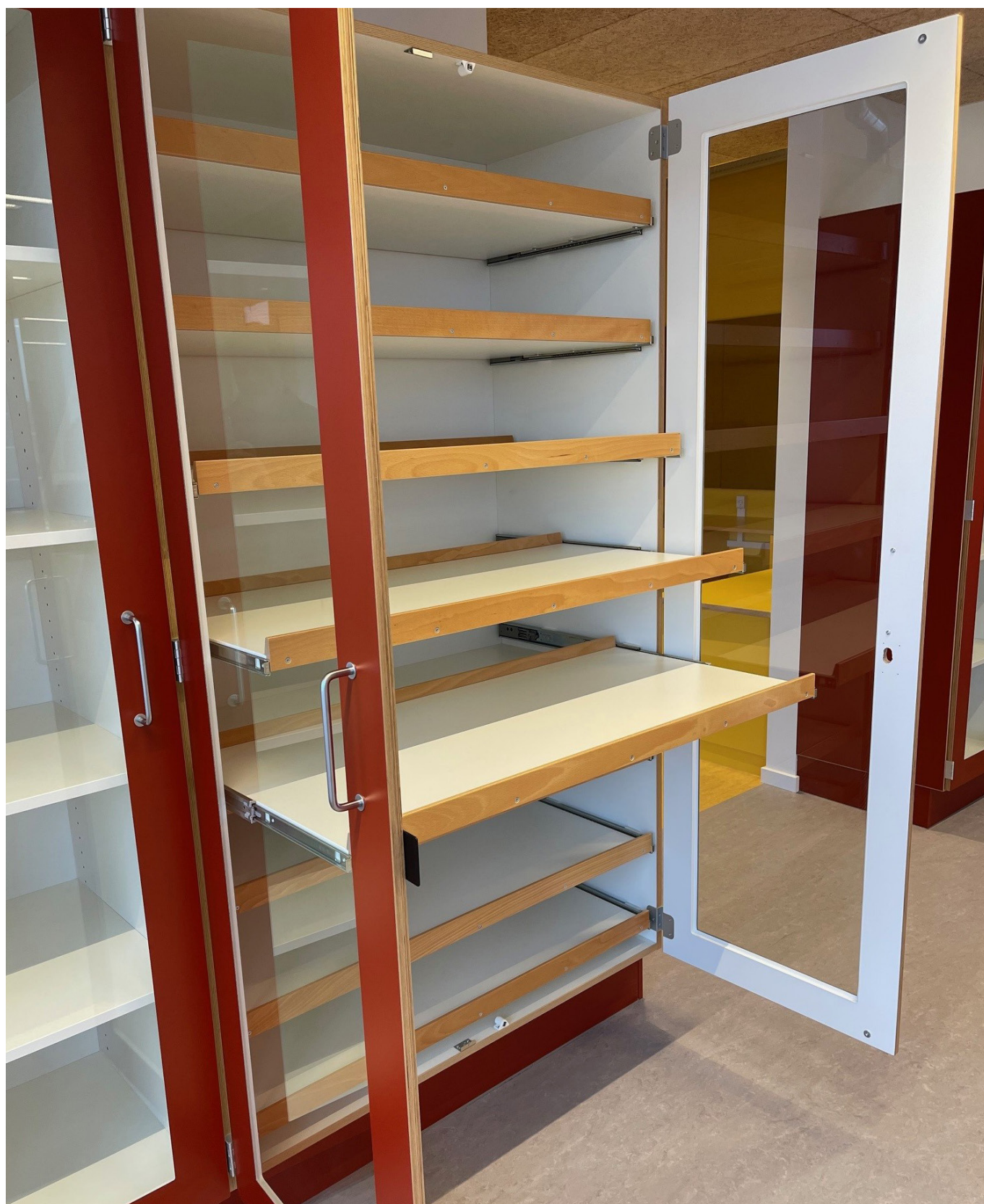
Skap for utstyr og materialer med rammedører og uttrekkshyller.
